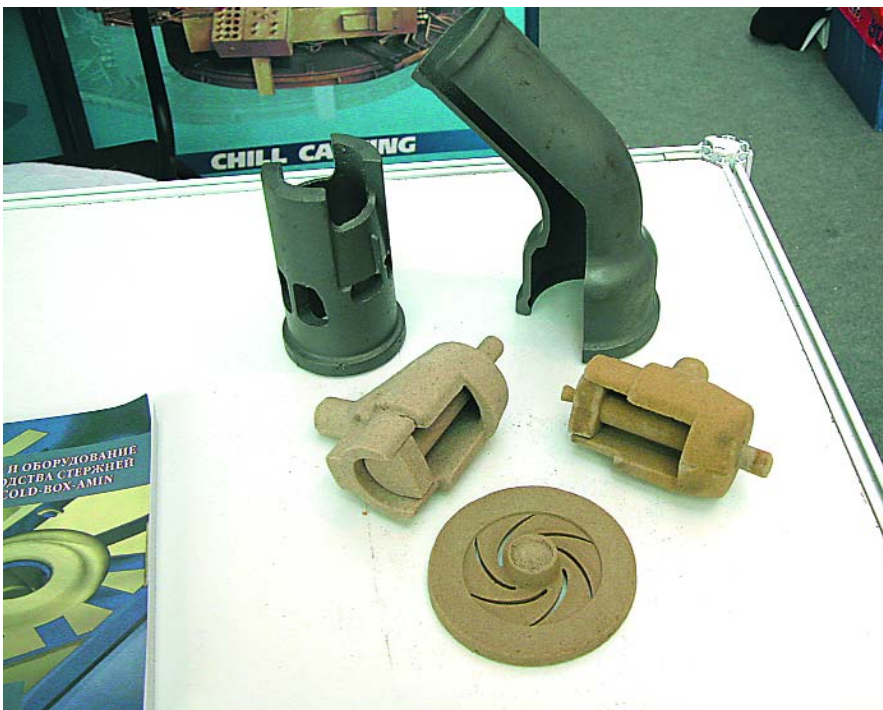
Образцы отливок, полученных методом литья в облицованные кокили
